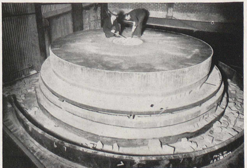
Bild 3. Nach 11 Monaten Abkühlzeit kommt der 5-Meter-Spiegel zum Vorschein. Arbeiter entfernen den Mittelkern. Der Rand der Scheibe trägt noch die Spuren der Gießform. Photo: Ayres A. Stevens
