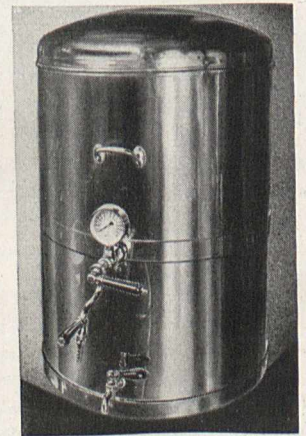
Bild 2. Behälter aus nichtrostendem Stahl für die Milchkonservierung nach dem Hofius-Verfahren
