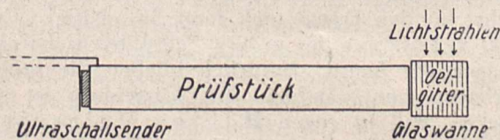
Bild 5. Anordnung zur Untersuchung von Eisen auf Materialfehler mittels Ultraschallwellen
