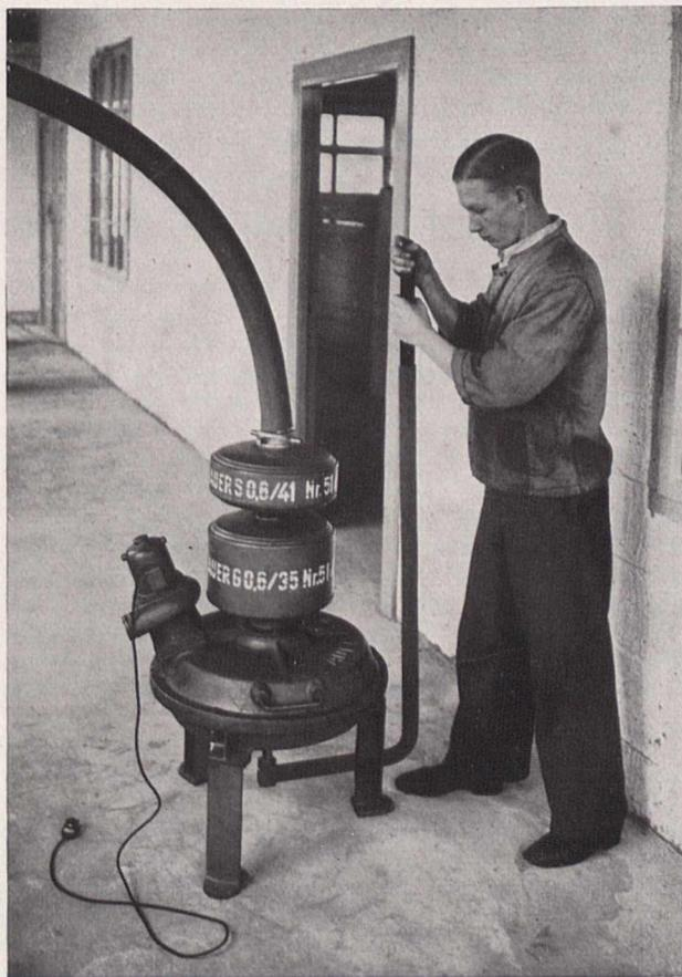
Bild 4. Schutzraumbelüfter mit elektrischem und Handantrieb
