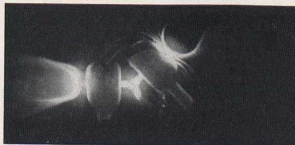
Bild 7 (oben). Der Bogen brennt „um die Ecke“. Bei mäßiger Stromstärke (50 A) bildet er eine abgerundete Schleife.
