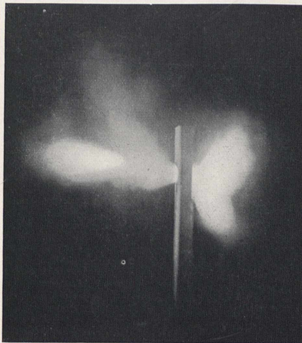
Bild 6. Der Lichtbogen wird eingeeengt. Er muß durch ein Loch hindurchbrennen.
