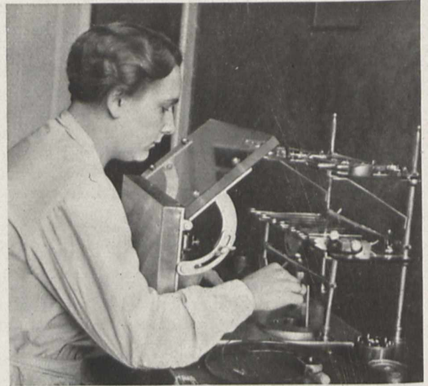
Bild 4. Arbeiten am Schutztisch, der durch Bleiplatten und Bleiglas die Strahlen abhält
