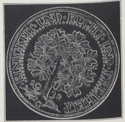
Fig. 2b. Dunkelfeldbeleuchtung bei schräg auffallendem Licht der Ringbeleuchtung
