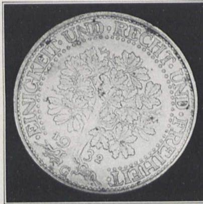
Fig. 2a. Hellfeldbeleuchtung bei zentral auffallendem Licht der Ringbeleuchtung
