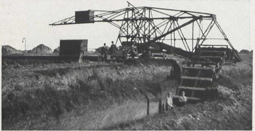
Fig. 5 Ablegeband des Torfbaggers (Fig. 6) mit automatischem Söndenableger
