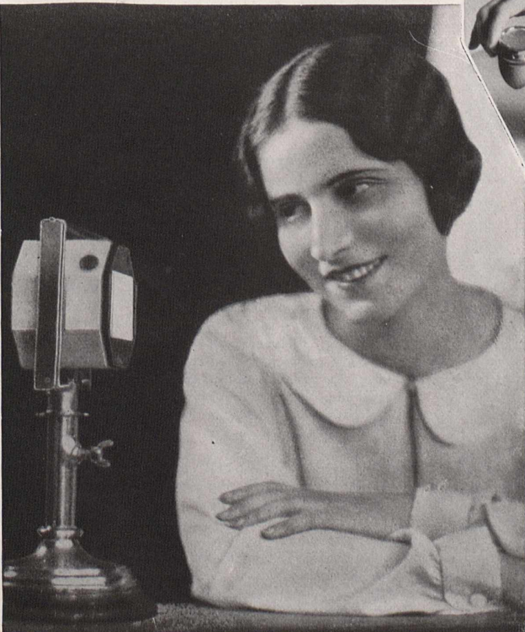
Fig. 1. Das Kondensator-Mikrophon ermöglicht eine viel klarere Ton-Wiedergabe, weshalb es neuerdings statt des bisher benutzten Reiss-Mikrophons (Fig. 2 unten) von vielen Sendern verwendet wird Fig. 3 (rechts). Das Kondensator-Mikrophon
