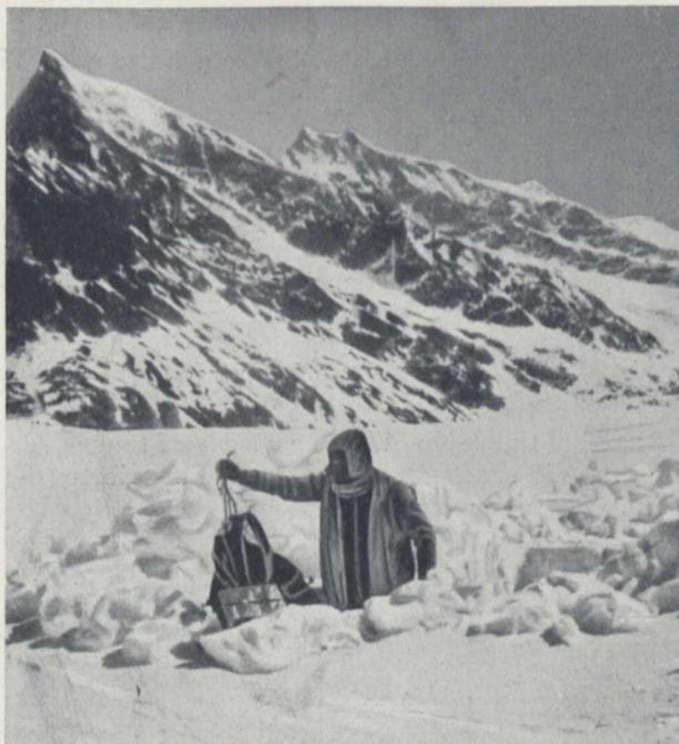
Fig. 5. Die Sprengladung ist in einem Schneeschacht auf dem großen Aletsch-Gletscher versenkt. Der Bergführer ordnet das Sprengkabel.
