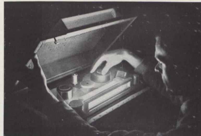
Fig. 4. Das schallsichere Aufnahme-Rhythmonom, geöffnet. Man sieht die 2 Rollen zum Auf- und Abwickeln des Filmbandes, das an dem langgestreckten erleuchteten Fenster (vorn) vorbeigeführt wird
