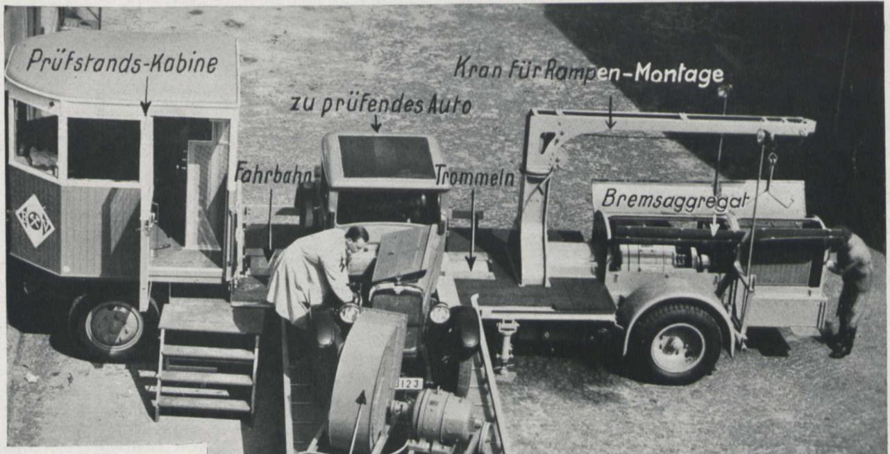
Drehzahl- bzw. Geschwindigkeitsmesser zur Kontrolle des Wagentachometers angebracht sowie die Verbrauchsmessgefäße, die durch einen Gummischlauch mit dem Vergaser des Wagenmotors verbunden sind. Die vom Wagen unfreiwillig erzeugte elektrische Energie wird in einem Widerstand in Wärme umgewandelt bis auf einen kleinen Anteil, der einen vor der Prüfung vor den Kühler geschobenen Ventilator — Ersatz des fehlenden Fahrtwindes — antreibt; ebenfalls heizt die An-
