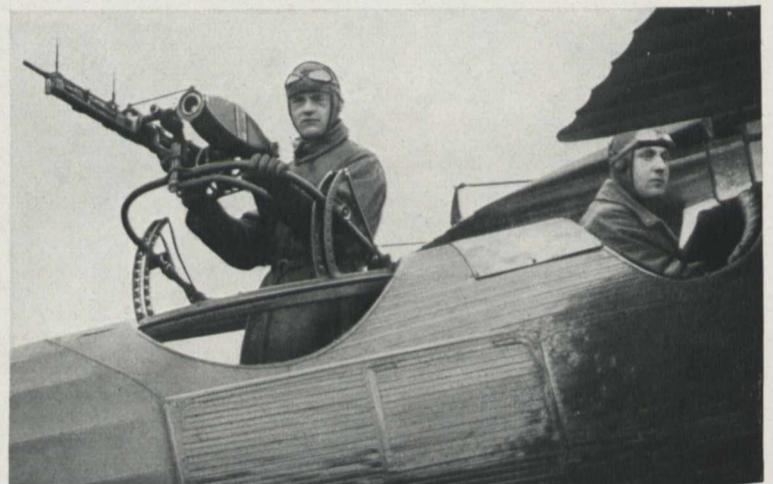
Fig. 2. Kinematographisches Maschinengewehr auf dem Beobachterstand eines Aufklärungsflugzeuges
