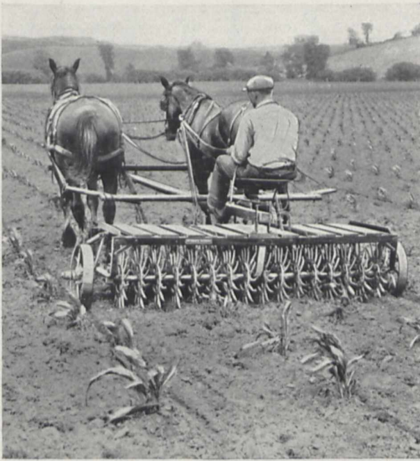
Fig. 3. Die rotierende Sternhacke erfüllt mit leichtem Gespann und einem Mann Bedienung die sonst so mühsame Arbeit der Bodenlockerung, Lüftung und Unkrautentfernung ohne die Kulturpflanzen (Rüben, Kartoffeln, Mais, Bohnen, Klee usw.) zu beschädigen
