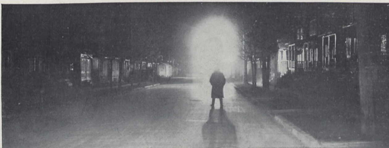
Fig. 3. Die Straßenbeleuchtung wurde eingeschaltet und ein Fußgänger mit dunklem Anzug in entsprechender Entfernung vor dem Wagen aufgestellt
