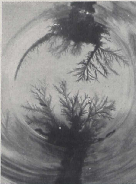
Fig. 1. Bleibaum, entstanden durch Eintauchen eines Zinkstabes in eine Bleilösung bei Verwendung eines stärkeren elektrischen Stromes.
