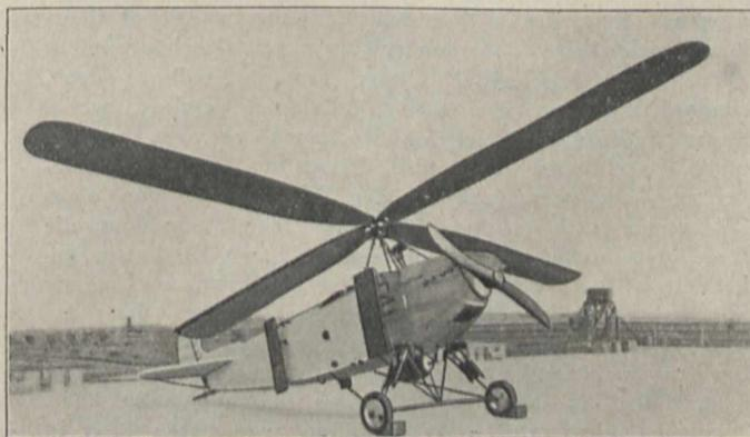
Fig. 3. „Chauvière“-Hubschrauber, dem Autogiro ähnelnd, ohne Flügelmotoren.
