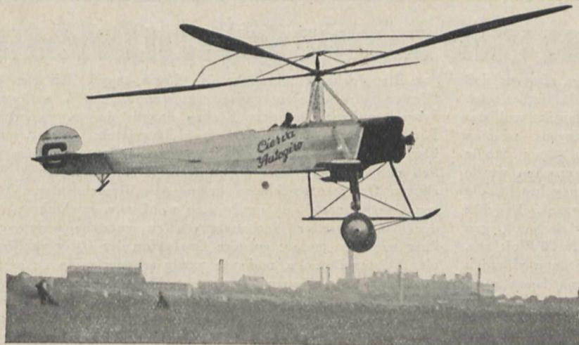
Fig. 1. „Autogiro“ des Spaniers de la Cierva, ohne Flügelmotoren.
