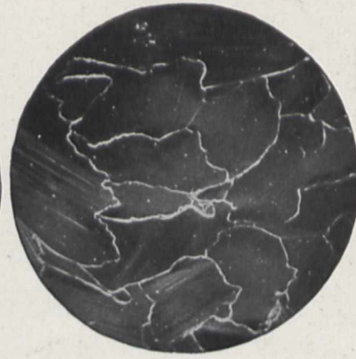
Auf der Glasplatte erstarrte Oberfläche eines Zinktropfens in 70facher Vergrößerung aufgenommen unter
