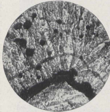
Fig. 5. Querschnitt durch eine elektrolytisch niedergeschlagene Nickelanode auf Nickelblech.
