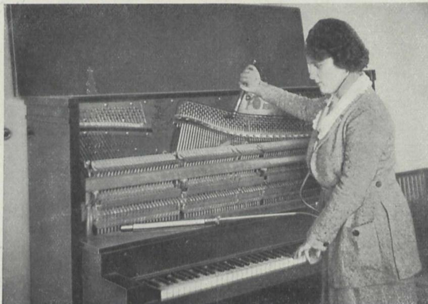
Fig. 1. Der Resonator wird zum Stimmen eines Klaviers verwendet.
