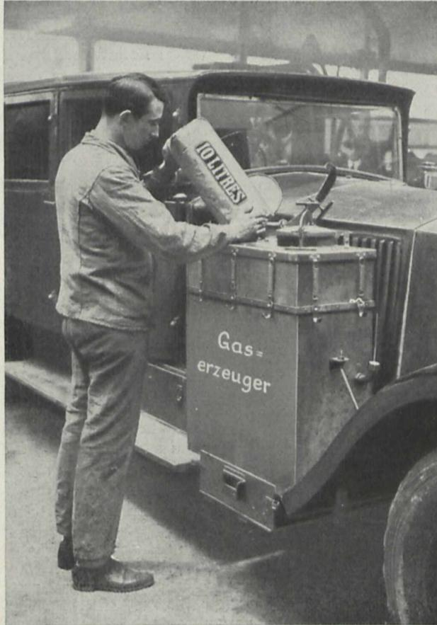
Fig. 3. Der Gaserzeuger wird mit dem Heizstoff Synthokarbon beschickt, der in Papiertüten verpackt ist.
