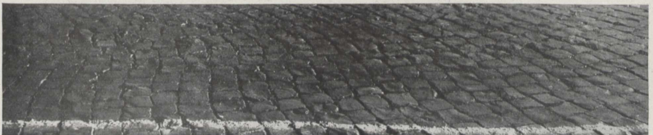
Fig. 13. Das Basalt-Kleinplaster-Stück der Versuchsstraße ist nach 49 Tagen fast unverändert.
