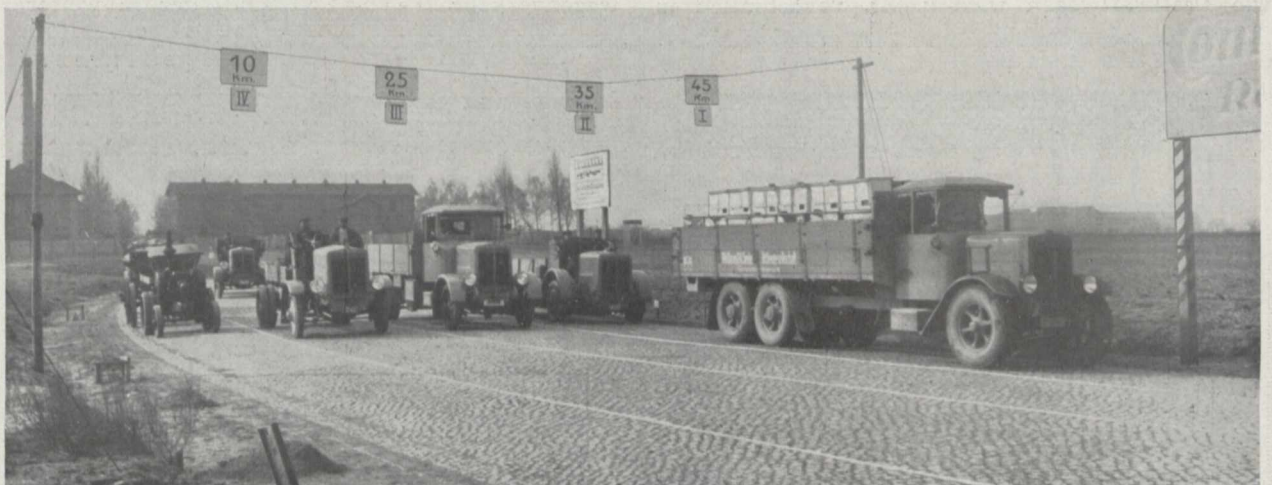
Fig. 9. Versuchsfahrt von leeren und beladenen Lastautos, die auf der Braunschweiger Versuchsstraße mit verschiedenen Geschwindigkeiten fahren, um die straßenzerstörenden Einflüsse festzustellen.
