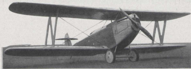
Fig. 4. Deutscher Caspar-Doppeldecker mit 310 PS-Junkers-Motor, mit dem Koennecke starten wollte.
