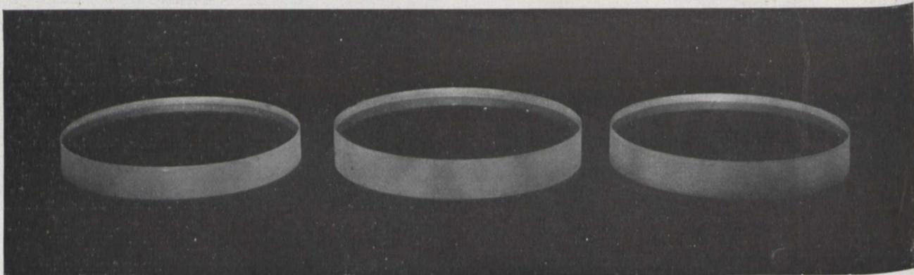
Fig. 1. Drei von M. Skinner geschliffene Quarzscheiben, deren Flächen höchstens zwei millionstel Millimeter von der mathematischen Ebene abweichen.
