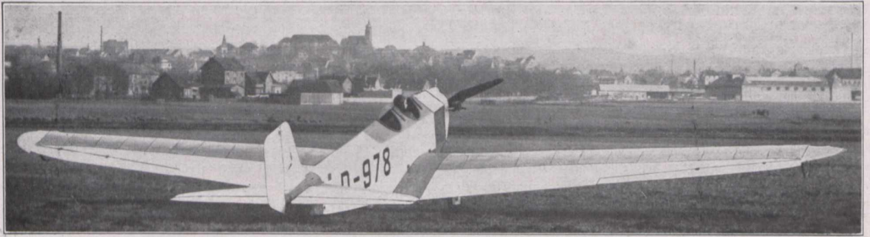
Fig 1. Das Klemm-Daimler-Leichtflugzeug mit 20 PS Mercedes-Motor, auf dem der Pilot Dr.-Ing. von Langsdorff 6700 m Höhe erreichte. (Vgl. d. Aufsatz in Heft 17.)
