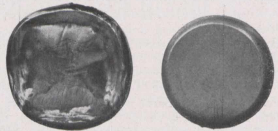
Fig. 3. Zusammengedrückte Kugeln aus Metall-Einkristall. mikrokristallinem Metall.
