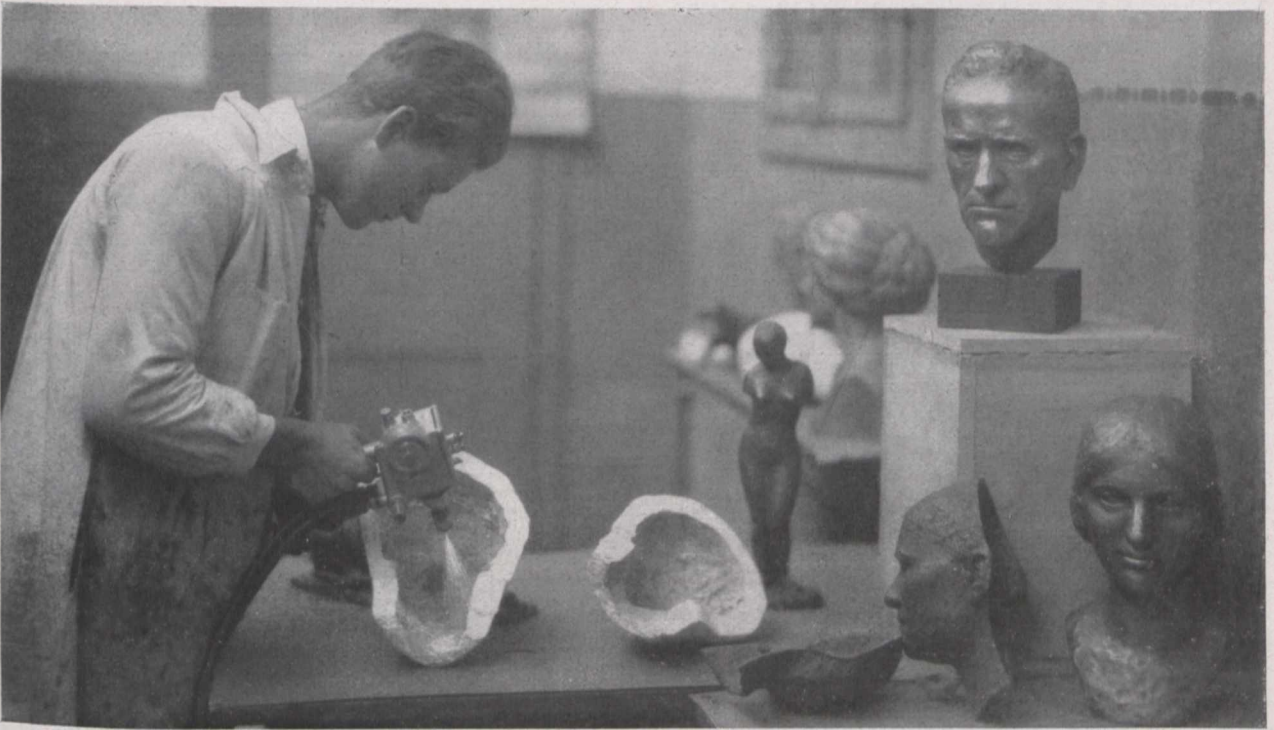
Fig. 1. Ausspritzen von Gipsformen mit der Metallspritz-Pistole.
