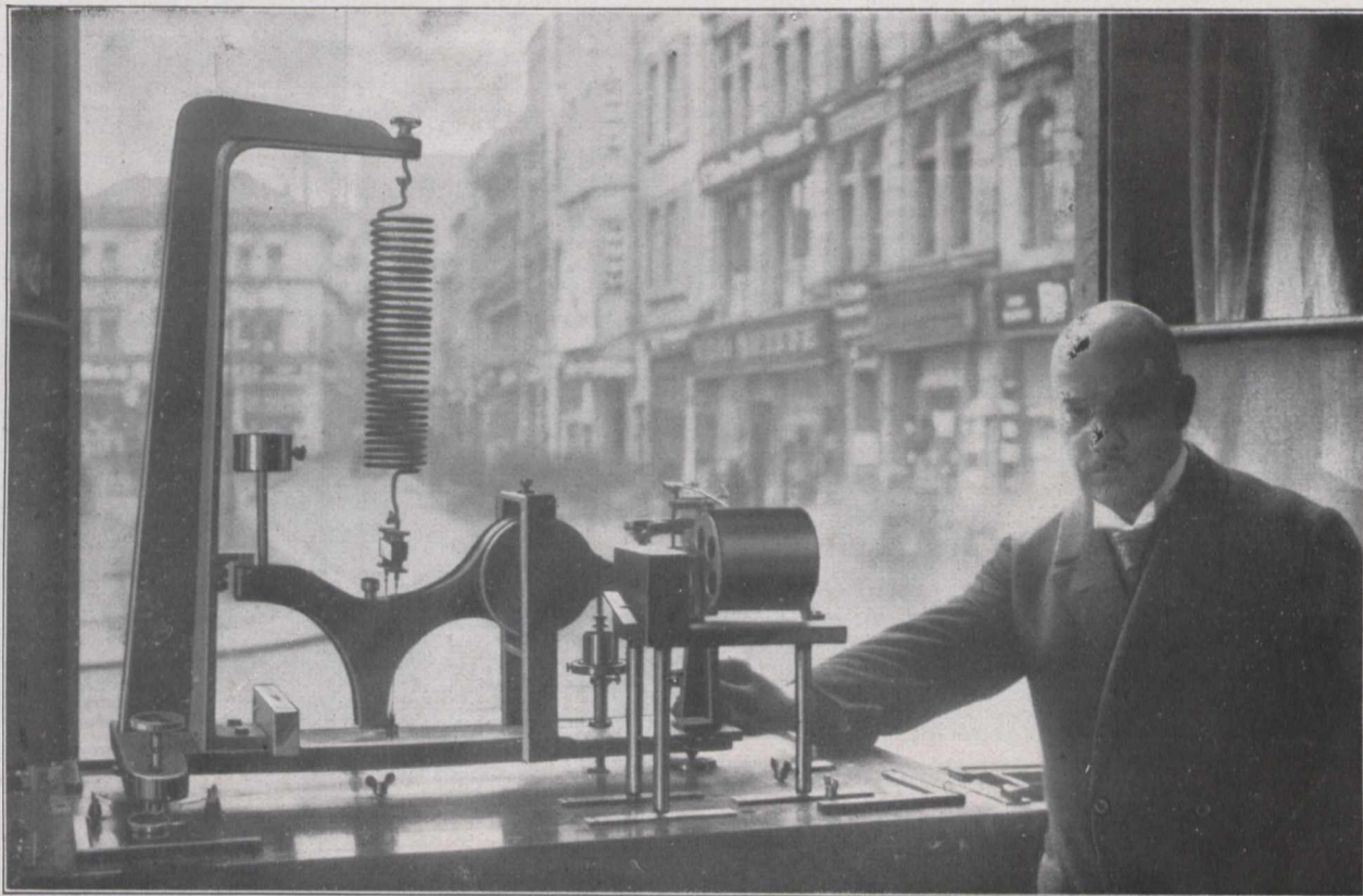
Fig. 1. Dipl.-Ing. H. Wittig an seiner Apparatur zur Messung der von Verkehrsfahrzeugen hervorgerufenen Erschütterungen.
