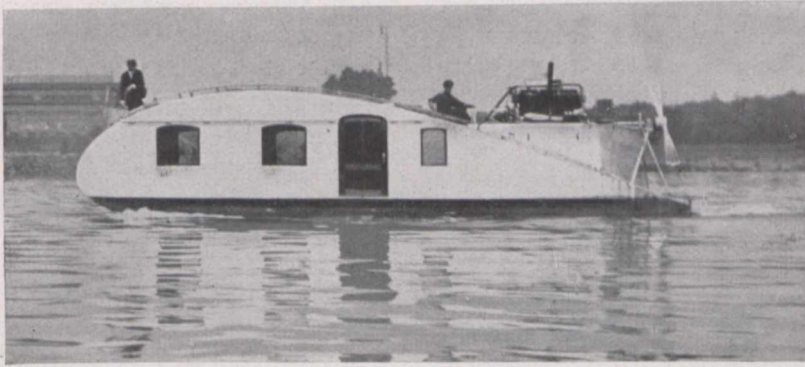
Fig. 3. Schnell-Verkehrsboot aus Leichtmetall mit Luftschaube von Fr. Lürssen Yacht- und Boots-Werft Vegesack b. Bremen.
