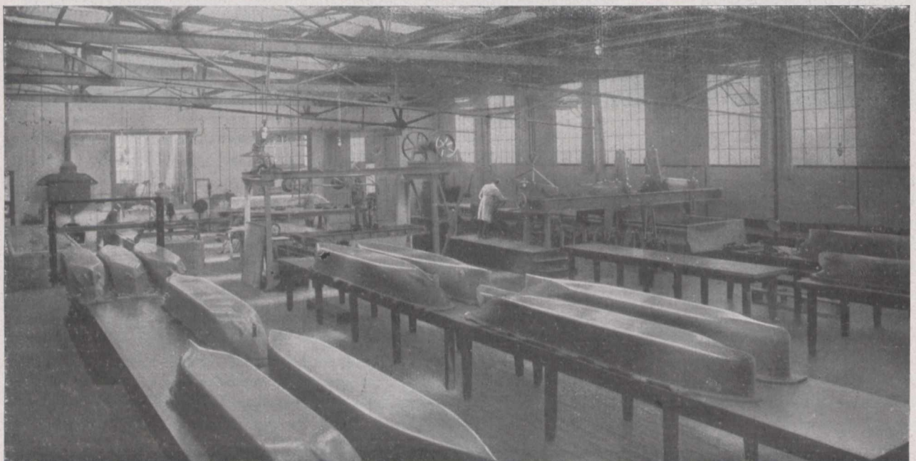
Fig. 2. Modellwerkstatt der „Hamburgischen Schiffbau-Versuchsanstalt“. Im Hintergrund links: Paraffinschmelzofen, rechts: kleine und große Modellfräsmaschine. Im Vordergrund: Schiffsmodelle aus Paraffin.
