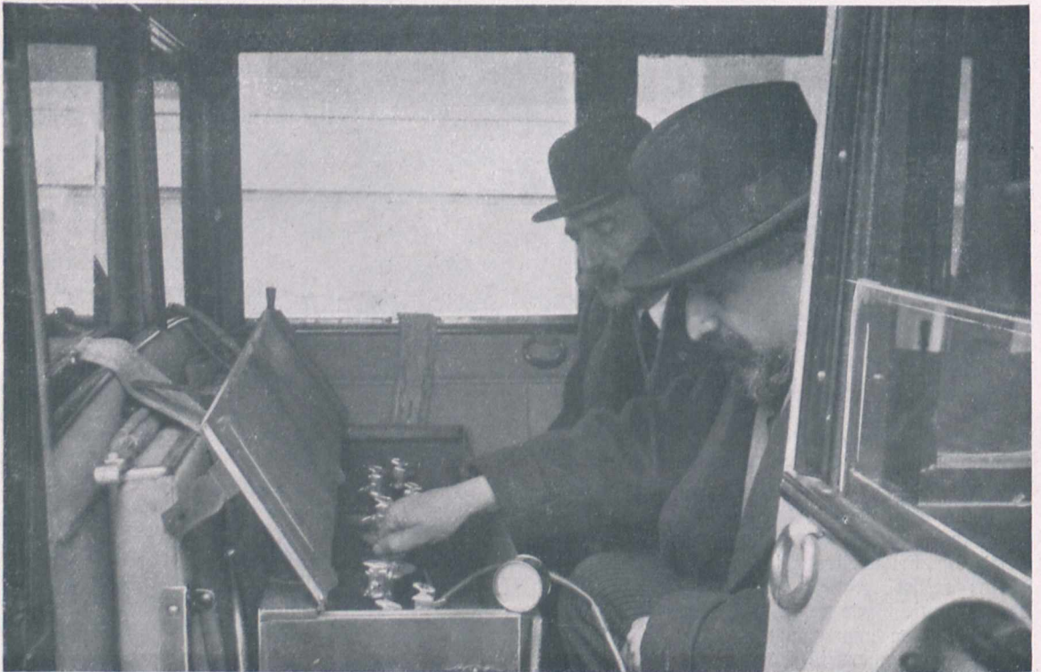
Fig. 1. Die Auspuffgase eines Autos werden während der Fahrt in einem eigens dazu konstruierten Apparat gesammelt.
