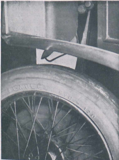
Fig. 3. Das Kupferrohr, welches die Gase zum Prüfapparat im Innern des Wagens leitet.
