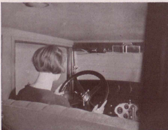
Fig. 1. Der neue Windschutz, ein Sicherheitsglas, das durch eingeschmolzene horizontale Stahldrähte verstärkt ist.
