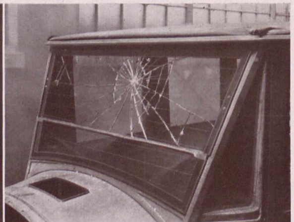
Fig. 2. Das Ergebnis eines Versuches. Von der Glasscheibe lösen sich infolge des Zusammenpralls mit einem Pendelgewicht Splitter los, doch bleibt der Windschutz in seiner Gesamtmasse intakt und gebrauchsfähig.
