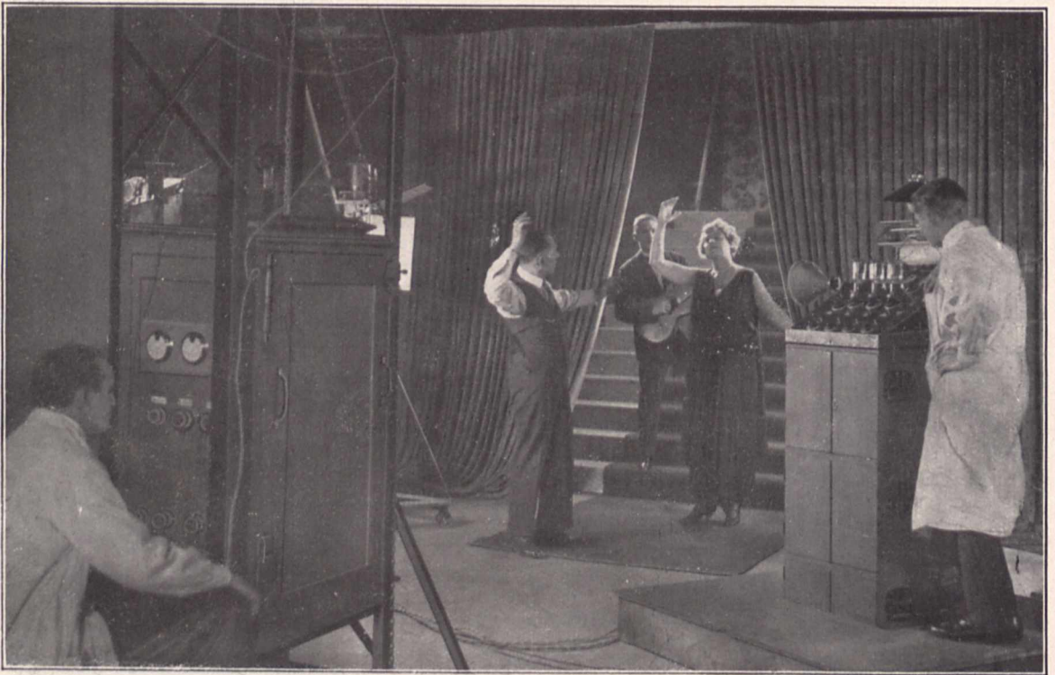
Fig. 4. Szene bei der Aufnahme. Rechts Verstärker mit Kathodophon.
