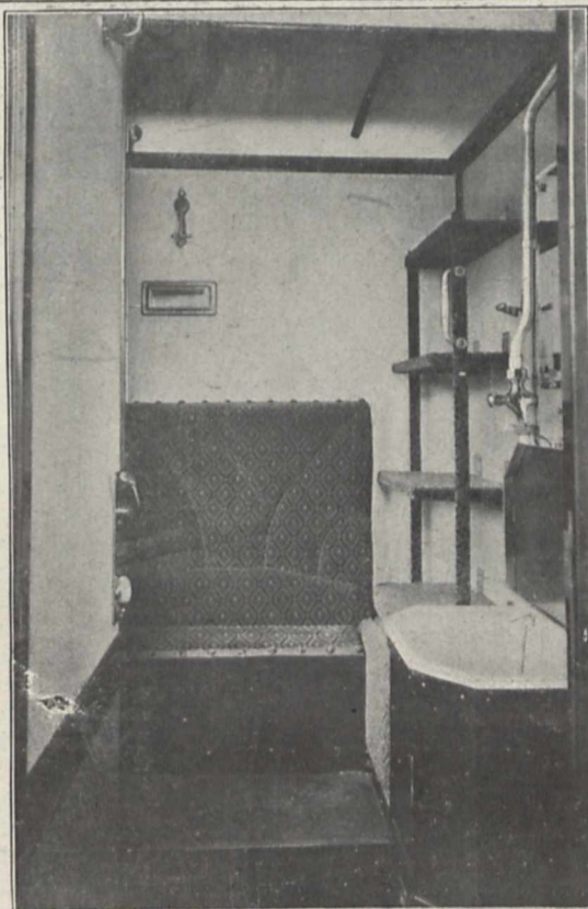
Fig. 4. Abteil 2. Klasse im neuen Schlafwagen. (Modell Wegmann) mit herabgelassenen Stufen zur Benutzung des Schlafrums.
