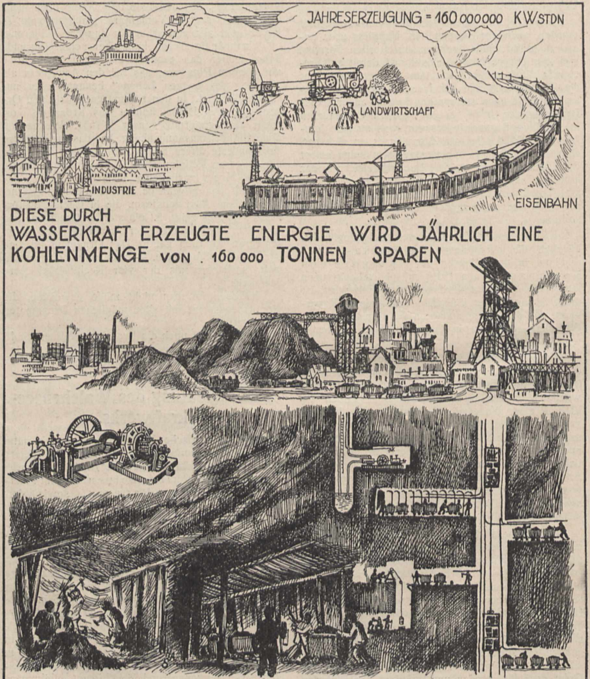
Fig. 1. Das Walchenseekraftwerk wird in Zukunft Bayern und dessen Grenzgebiete mit einer Energiemenge versorgen, zu deren Erzeugung bisher 160 000 Tonnen Steinkohle nötig sind (= täglich ein Eisenbahnzug von ca. 50 Wagen). — Tausende von Bergarbeitern werden aus ihren Maulwurfsgängen wieder in's Freie zurückkehren.
