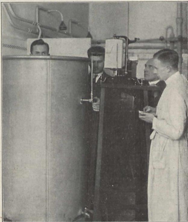
Fig. 2. Bestimmung des spezifischen Körpergewichts an Sportlern durch Tauchversuch in einer Zylinderwanne.
