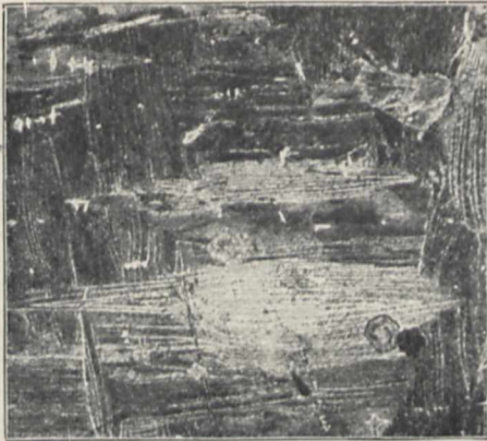
Fig. 7. Legierung aus 15% Chrom und 85% Gold, geätzt mit Königswasser (100mal vergrößert).
