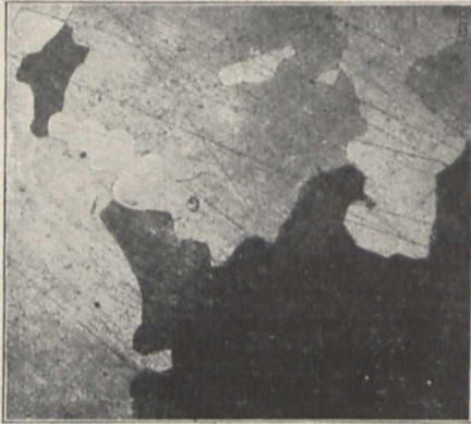
Fig. 3. Legierung aus 5% Chrom und 95% Gold, geätzt mit Königswasser.
