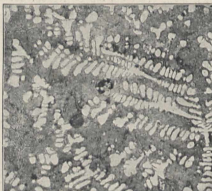
Fig. 5. Legierung aus 50% Chrom und 50% Gold, geätzt mit Königswasser.
