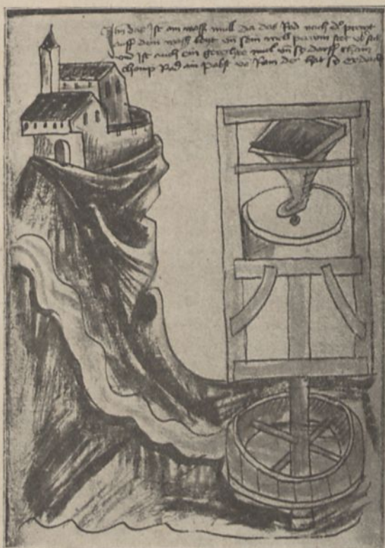
Turbine mit Mühle gekuppelt, die Erfindung eines Papstes, gemalt um 1430.
