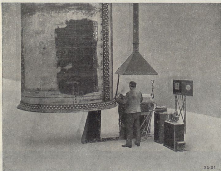
Kontrolle der Nietung bei der Herstellung Lanzscher Lokomobilkessel mit dem Nietkontrollapparat System Schuch.
