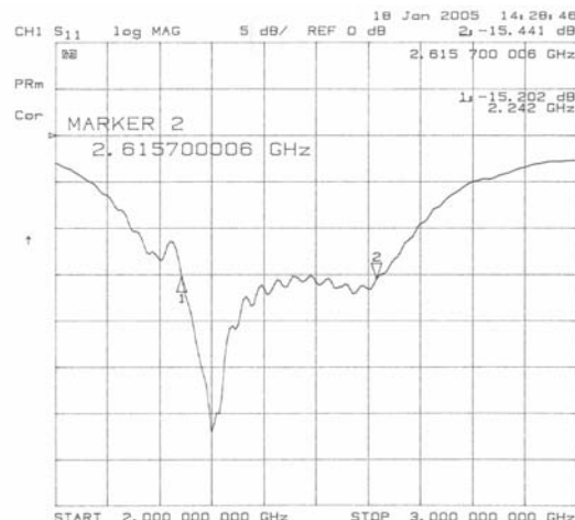
Rys. 4.22. Charakterystyka dopasowania impedancyjnego promiennika sprzężonego elektromagnetycznie z symetryczną linią paskową. Wyniki pomiarów
