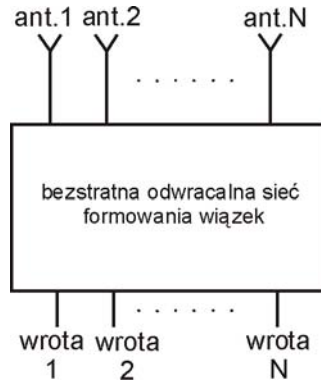
Rys. 2.15. Bezstratna odwracalna sieć formowania wiązek o N wrotach wejściowych i N wrotach wyjściowych
