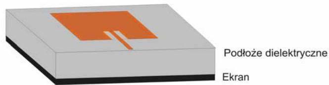
Rys. 4.1. Antena zasilana linią mikropaskową umieszczoną na wspólnej powierzchni
