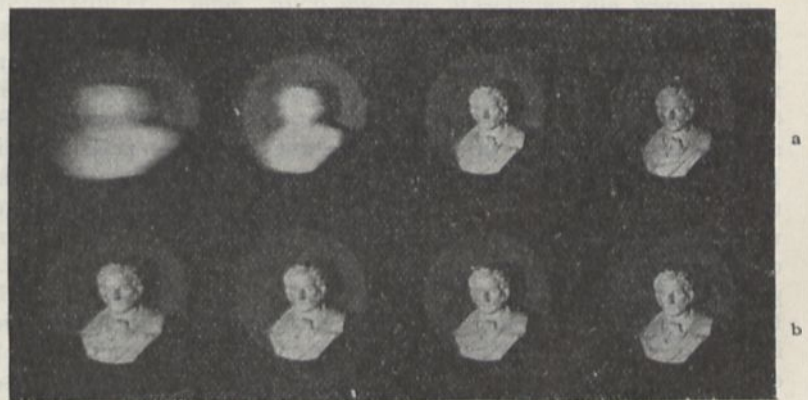
a) Aufnahmen einer Büste durch ein bikonvexes Starglas von 13 Dioptrien. b) „ „ „ „ Katralglas von 13 Dioptrien.
