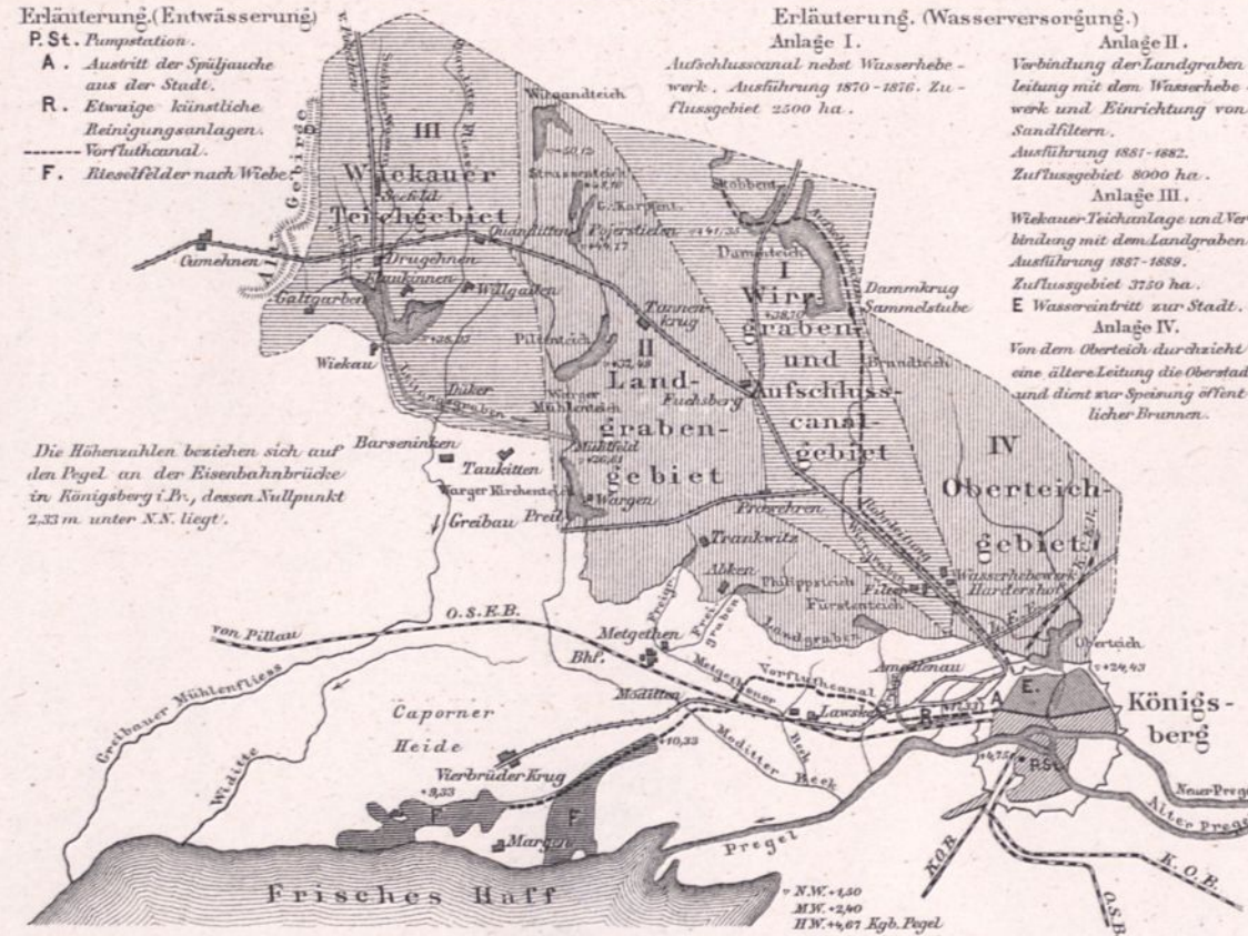
Abb. 1. Uebersichtsplan der Wasserversorgungs- und Entwässerungsanlagen. 1:200000.
