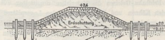
Querschnitt des im flachen Wasser angelegten Deiches.
