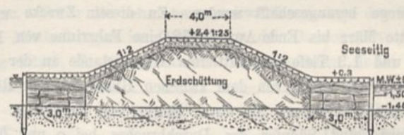
Querschnitt des im tiefen Wasser angelegten Deiches.
