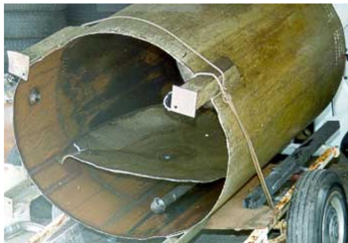
Rys. 3.9. Uszkodzony zbiornik magazynowy oleju
