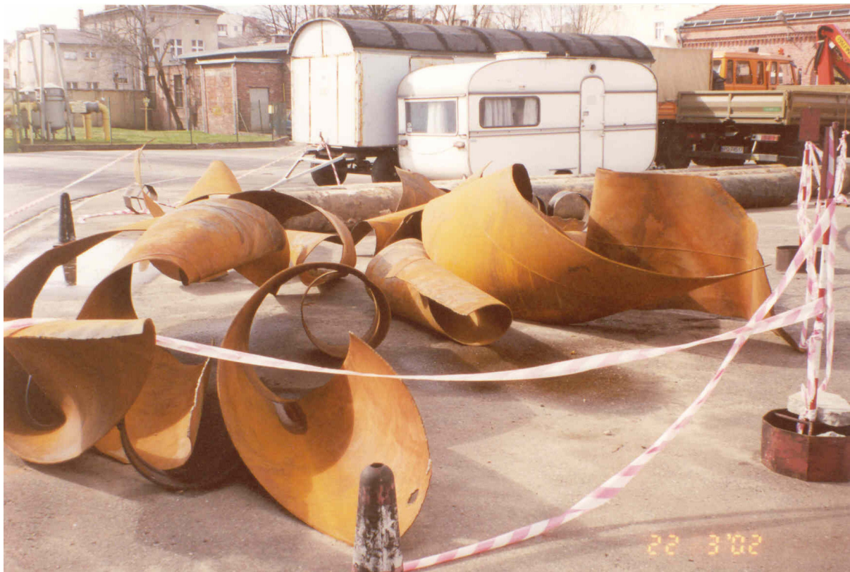
Rys. 3.4. Fragmenty rur gazociągu po eksplozji – zerwanie wzdłuż szwu spiralnego
