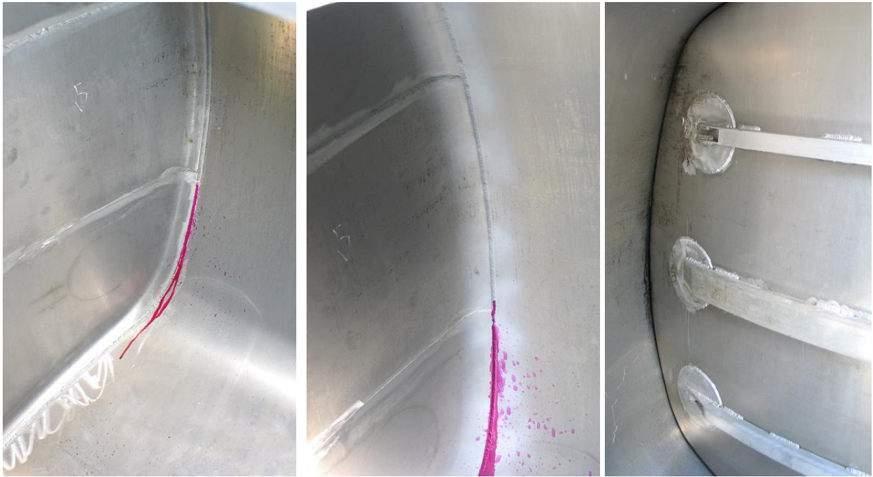
Rys. 3.8. Pęknięcia spoin przegród w cysternie samochodowej
