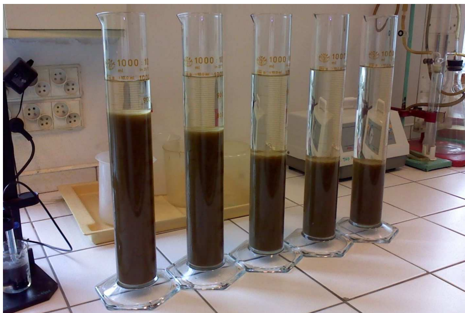
Fot. 1. Cylindry z osadem podczas badań zagęszczania grawitacyjnego
