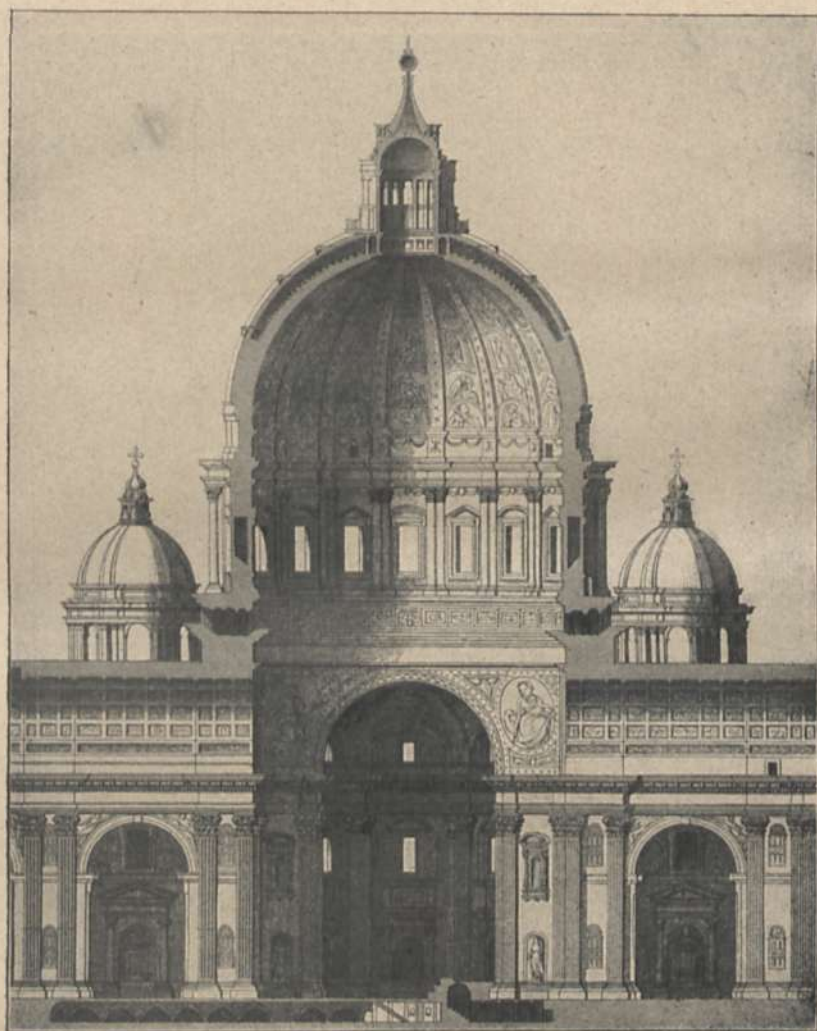
Abb. 48. Schnitt durch die Kuppel von St. Peter in Rom.
