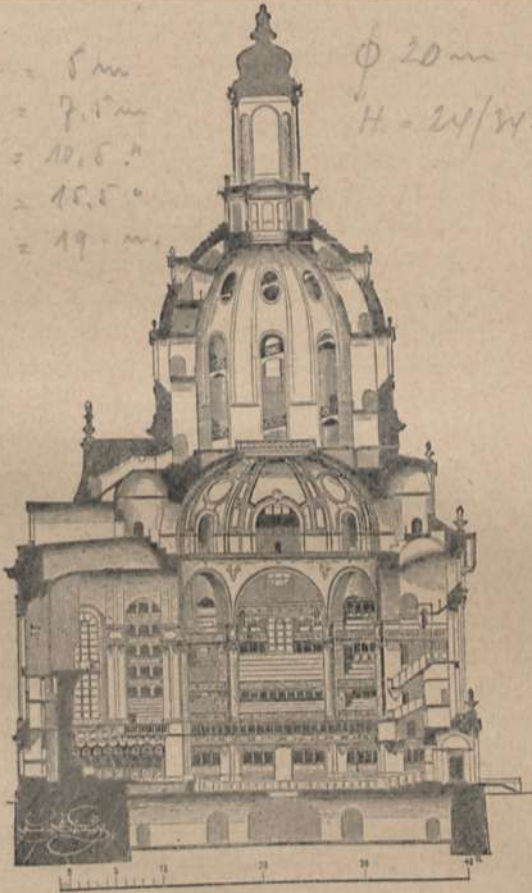
Abb. 93. Längsschnitt der Frauenkirche in Dresden.
