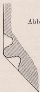
Abb. 14. Eckgliederung der Pfeiler in der Pfarrkirche in Massow.
