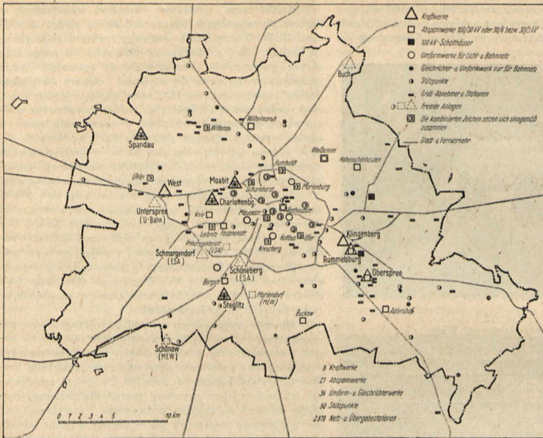
Rys. 14. Główne instalacje elektryczne Berlina w 1933 r.
