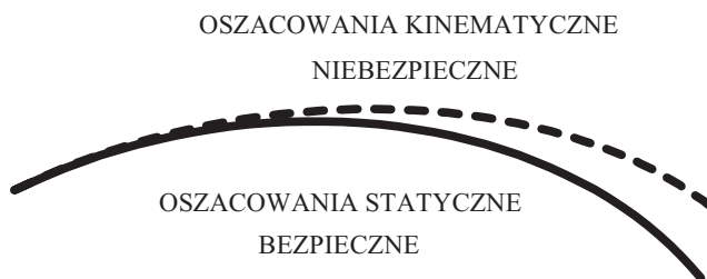
Rys. 3.1.1. Kresy oszacowań statycznych i kinematycznych Fig. 3.1.1. Limits of the static and kinematic estimations
