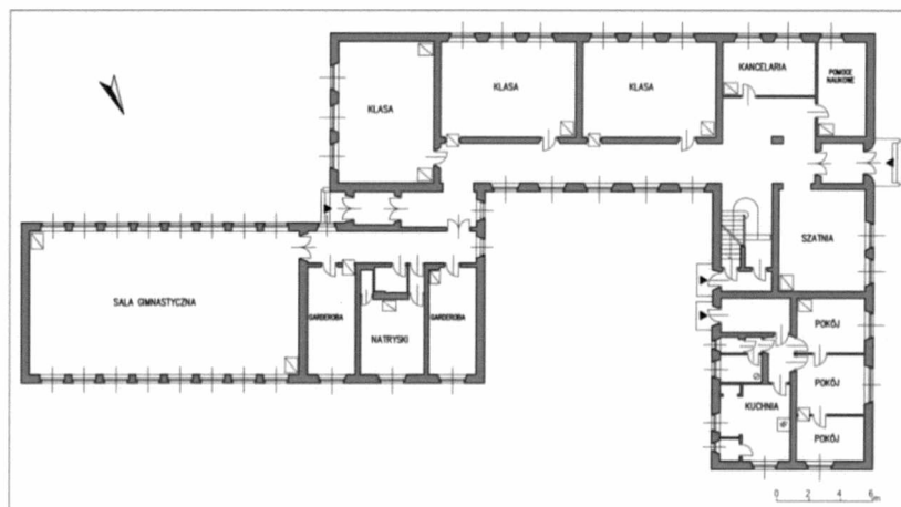
Ryc. 232. Rzut pierwszej kondygnacji szkoły o konstrukcji murowanej w Siedliskach (powiat krasnostawski), oprac. autor na podstawie projektu z 1938 roku, APL, UWL, WKB, sygn. 1242.
