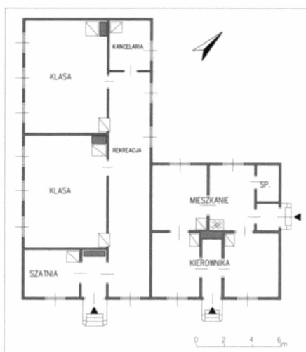
Ryc. 206. Rzut parteru szkoły dwuklasowej o konstrukcji drewnianej w Przekopie (powiat sokołowski), oprac. autor na podstawie projektu z 1938 roku, APL, UWL, WKB, sygn. 2310.
