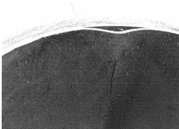
Rys. 5.18. Szczelina zmęczeniowa w stalowym linerze uszkodzonego testowego zbiornika typu 3-go, po przeprowadzonej serii badań cyklicznych.
