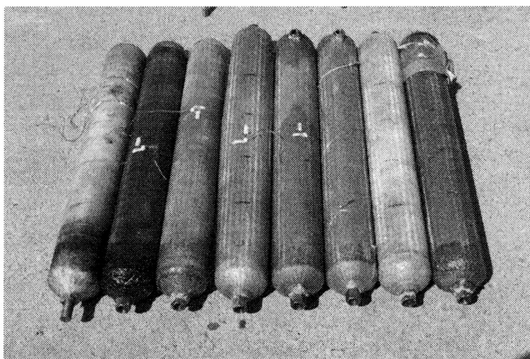
Rys. 6.23. Kompozytowe zbiorniki ciśnieniowe wykonane w technologii wyplotu włókna ciągłego.
