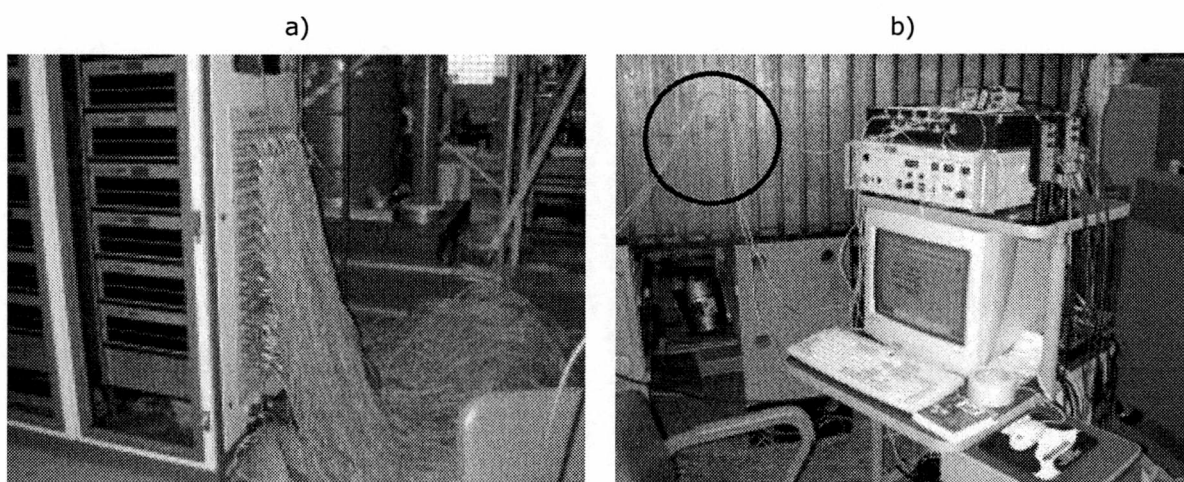
Rys. 3.11. Okablowanie strukturalne dla czujników tensometrycznych (a) oraz światłowodowych – zaznaczone okręgiem (b) (na podst. [96]).
