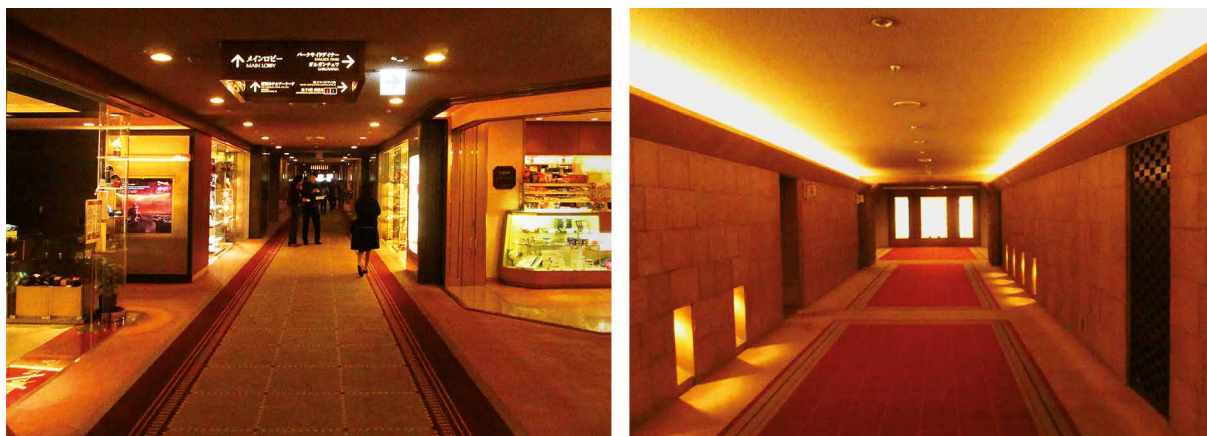
Fot. 12. Geometria wnętrza i kierunek ruchu wyeksponowane z użyciem kontrastowych listew przypodłogowych, pasów na wykładzinach i opraw świetlnych w Imperial Hotel, Tokio (Japonia). [Fot. J.J.]
