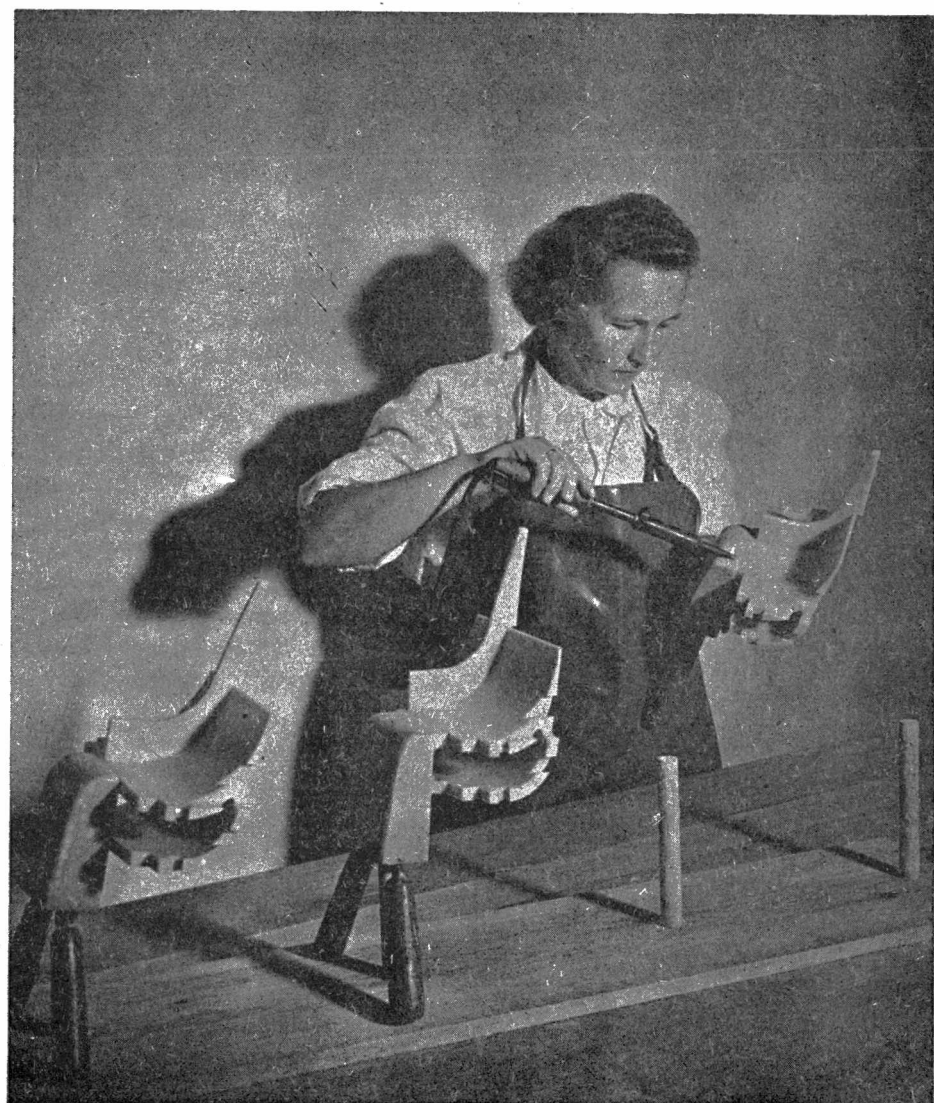
Wykańczanie modeli woskowych na odlewy precyzyjne
