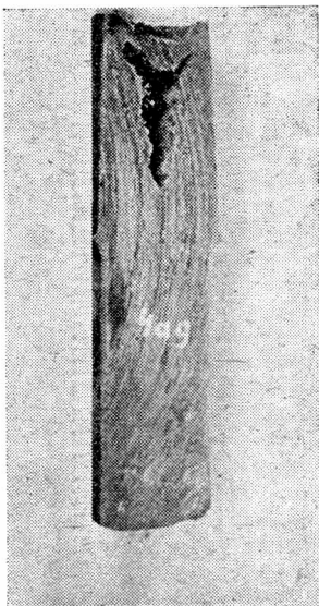
Rys. 4. Kształt jamy skurczowej w nadlewie zwężającym
