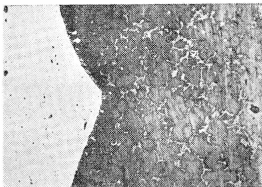
Rys. 4. Mikrostruktura złącza stal—brąz; pow. 100 ×; trawiono elektrolitycznie
