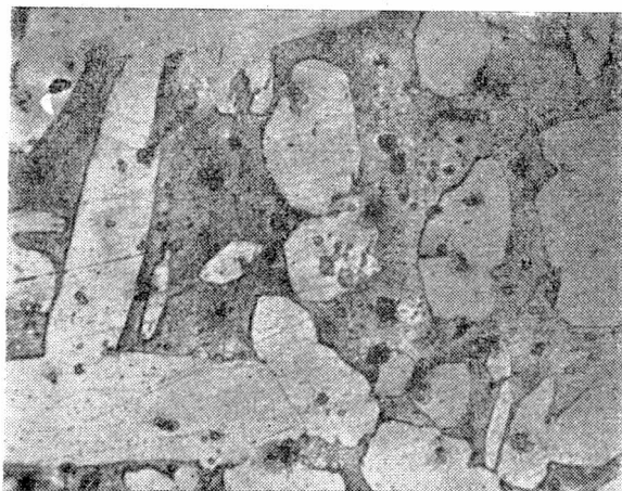
Rys. 2. Struktura mosiądzu niklowego LN 56-3, traw. \text{FeCl}_3 , pow. 500 \times
